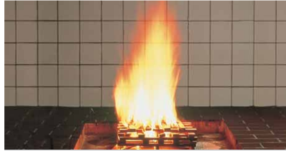
Test yangını 1: açık selüloz yangını (ahşap)
