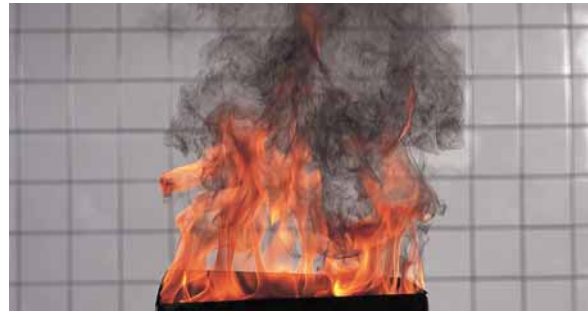
Test yangını 5: sıvı yangını (n-heptane)
